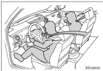
Os pré-tensionadores possibilitam uma maior proteção dos ocupantes ao retrain rapidamente os cintos de segurança quando o veículo é submetido a determinados tipos de colisão frontal grave.
