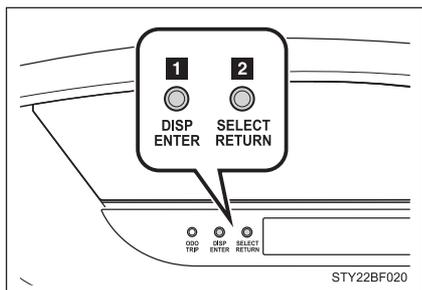
O mostrador multifunção é acionado usando-se os interruptores do painel de instrumentos.
