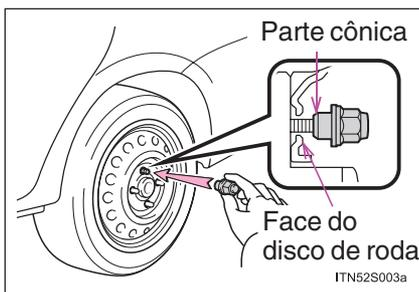
Ao substituir uma roda de alumínio por uma roda de aço, aperte as porcas até que a parte cônica esteja em contato com a face do disco da roda.
