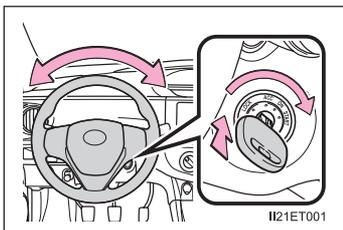
Durante a partida do motor, a chave de ignição poderá parecer estar emperrada na posição “LOCK”. Para liberá-la, gire a chave e mova o volante de direção levemente em qualquer sentido.
