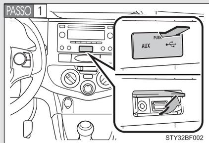
Abra a tampa e conecte um iPod usando o cabo.
