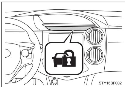
**PASSO 4** Retorne a chave de ignição para a posição “LOCK” e posicione-a em “ON”. Repita essa etapa 01 vez e mantenha a chave em “ON”.
