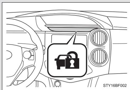
Feche as portas, capô do motor e porta-malas, e trave todas as portas usando o controle remoto. O sistema será ativado automaticamente após 30 segundos.
