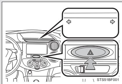
Pressione o interruptor para piscar todos os sinalizadores de direção. Para desativá-los, pressione novamente o interruptor.
