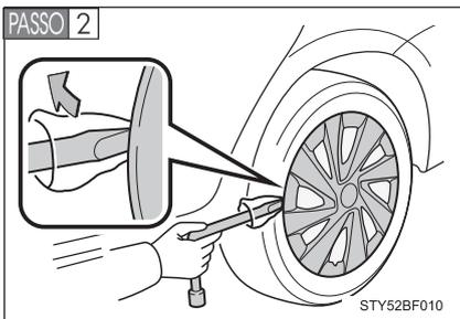
Para veículos com calota integral, remova a calota usando a chave de aperto.
