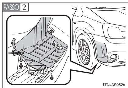
Remova os parafusos e a presilha do revestimento do para-lama.
