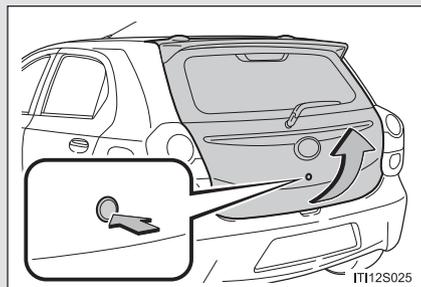
Pressione o interruptor de abertura da porta traseira e levante-a. Caso a porta não esteja totalmente destravada, pressione o interruptor novamente.
