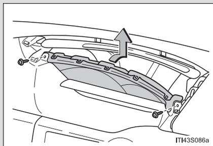
Remova ambos os parafusos e a seguir, remova o conjunto dos instrumentos.
