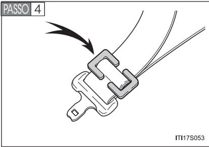
Instale a presilha de travamento próximo à lingueta do cinto de segurança (ombro e quadril) inserindo o cinto nos rebaixos da presilha de travamento. Trave o cinto novamente. Se houver folga no cinto, destrave a fivela e reinstale a presilha de travamento. (→P. 1-1-36)
