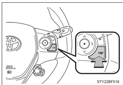
Comuta entre os itens hodômetro, hodômetro parcial e controle de luminosidade do painel de instrumentos, pressionando-se o botão “TRIP” no volante de direção.
