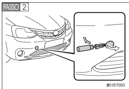
Remova a tampa do olhal usando uma chave de fenda.
