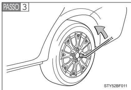
Solte levemente as porcas da roda (uma volta).
