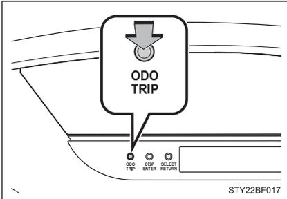
Comuta entre os itens hodômetro, hodômetro parcial e controle de luminosidade do painel de instrumentos, pressionando-se o botão “ODO/TRIP” no painel de instrumentos.
