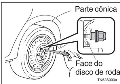
Ao substituir uma roda de liga leve por uma roda de aço, aperte as porcas até que a parte cônica esteja em contato com a face do disco da roda.
