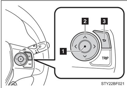
O mostrador multifunção é acionado usando-se os interruptores de controle dos instrumentos.
