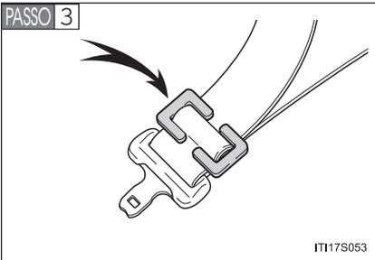
Instale a presilha de travamento próximo à lingueta do cinto de segurança (ombro e quadril) inserindo o cinto nos rebaixos da presilha de travamento. Trave o cinto novamente. Se houver folga no cinto, destrave a fivela e reinstale a presilha de travamento. (→P. 1-1-35)
