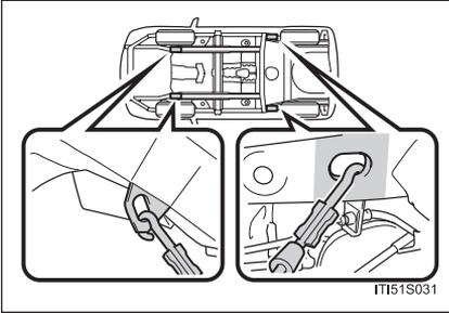
Se for transportado por um caminhão de plataforma, o seu veículo Toyota deverá ser amarrado nas posições indicadas na ilustração.
