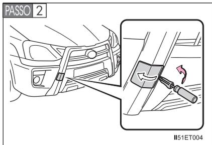
Remova a tampa do olhal usando uma chave de fenda.
