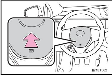
Para acionar a buzina, pressione a marca ou próximo da marca
