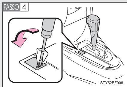
Force a tampa para cima, utilizando uma chave de fenda de ponta chata ou ferramenta similar.
