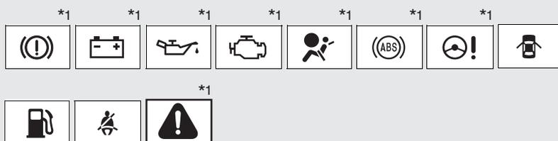
\*1: Estas luzes irão acender quando a chave de ignição for posicionada em “ON” para indicar que a inspeção do sistema está sendo executada. As luzes irão apagar após a partida do motor, ou após alguns segundos. Poderá haver impropriedade em um sistema se uma luz não acender, ou se as luzes não apagarem. Providencie a inspeção do veículo em uma Concessionária Autorizada Toyota.
