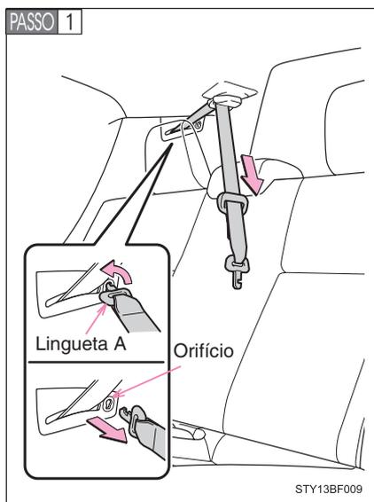
Gire a lingueta A e a seguir remova-a do orifício, conforme indicado na ilustração.
