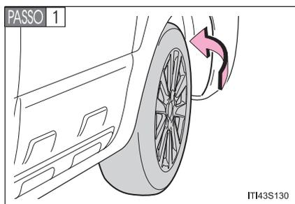
Para permitir espaço de trabalho suficiente, gire o volante de direção para o lado oposto da lâmpada a ser substituída.
