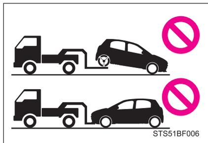
Certifique-se de transportar o veículo com as rodas dianteiras levantadas ou com as quatro rodas fora do solo. Caso o veículo seja rebocado com as rodas dianteiras em contato com o solo, o conjunto de tração e as peças relacionadas poderão ser danificadas.
