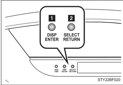
O mostrador multifunção é acionado usando-se os interruptores do painel de instrumentos.
