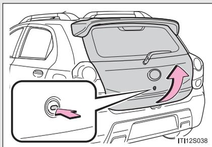
Pressione o interruptor de abertura da porta traseira e levante-a. Caso a porta não esteja totalmente destravada, pressione o interruptor novamente.
