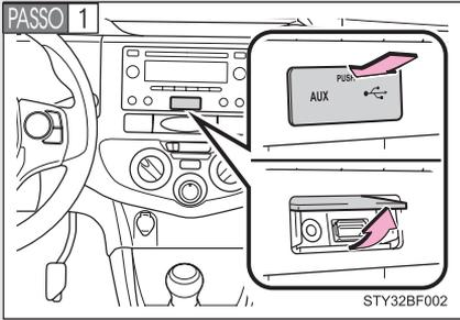
Abra a tampa e conecte um iPod usando o cabo.
