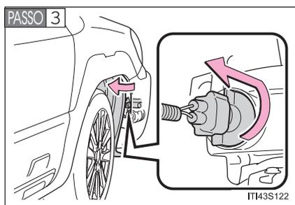
Remova parcialmente o revestimento do para-lama e gire a base da lâmpada no sentido anti-horário.
