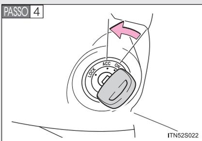
Desligue o motor posicionando a chave de ignição em “ACC”.
