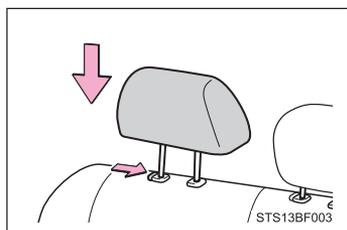
Alinhe o apoio de cabeça com os furos de instalação e empurre-o para baixo na posição de travamento.
