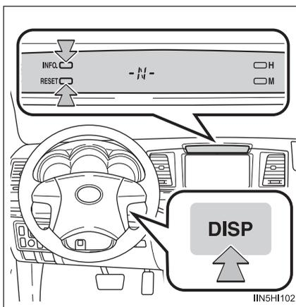
3 Dirija o veículo a uma velocidade de 8 km/h ou inferior em círculo até que a direção seja apresentada no mostrador.
