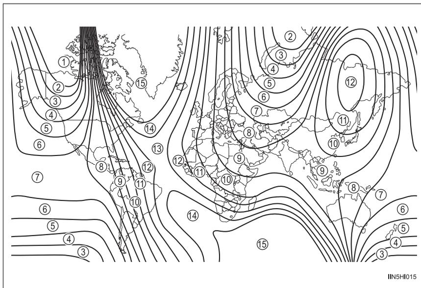
O mostrador de direção na bússola desvia da direção real determinada pelo campo magnético da terra. A quantidade de desvio varia conforme a posição geográfica do veículo.
