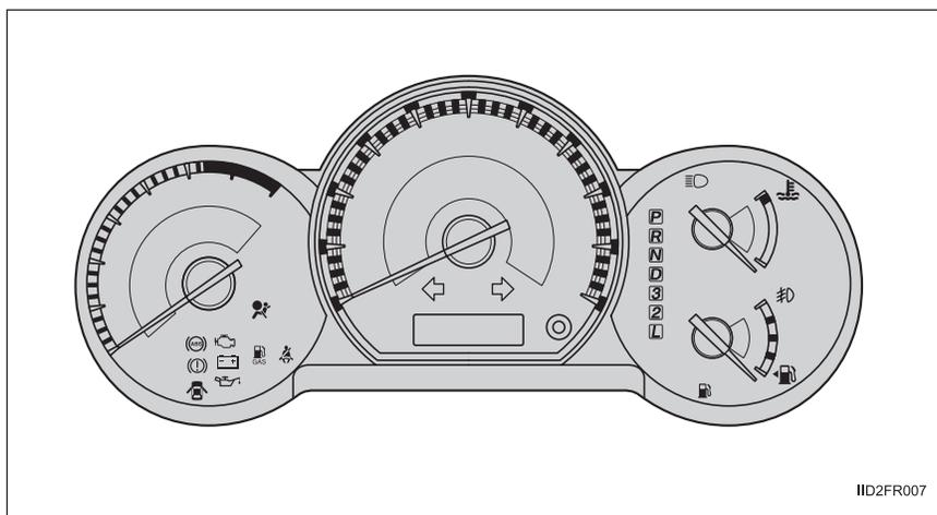
► Conjunto do painel de instrumentos (Optitron)
