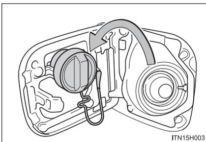
**Abrir a tampa do sub-tanque (somente veículos com motor flex)**
