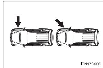
Os airbags laterais e de cortina em geral não inflam se o veículo for envolvido em uma colisão frontal ou traseira, se capotar, ou ainda em caso de colisão lateral em baixa velocidade.
