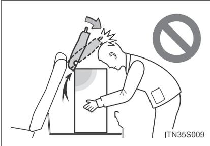
Seja cauteloso ao acondicionar itens que excedam a altura do ponto de fixação da cobertura do compartimento de bagagem.
