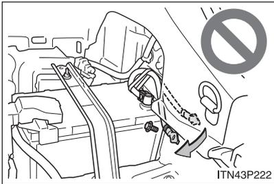
Não desconecte o terminal negativo (-) na lateral do corpo, como mostrado. O terminal negativo (-) desconectado pode tocar o terminal positivo (+), o que pode causar um curto e resultar ferimentos graves ou fatais.
