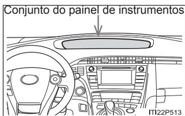
Não coloque nada nem cole adesivos na frente do conjunto do painel de instrumentos. O objeto pode deixar o painel mais escuro, obstruir o visor ou pode causar reflexo, ocasionando um acidente.
