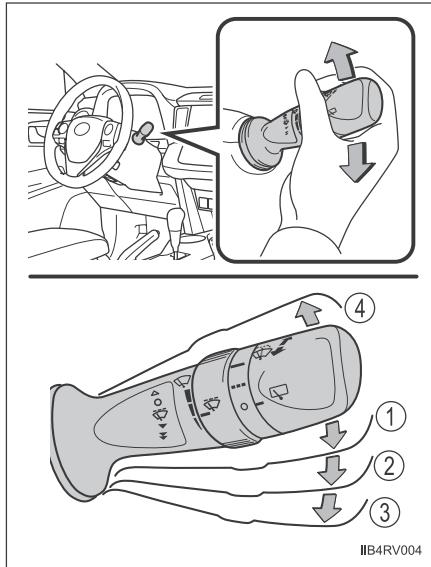
Se equipado, os intervalos do limpador podem ser ajustados quando a operação intermitente for selecionada
