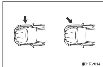
Os airbags laterais em geral não inflam se o veículo for envolvido em uma colisão frontal ou traseira, se capotar, ou ainda em caso de colisão lateral em baixa velocidade.
