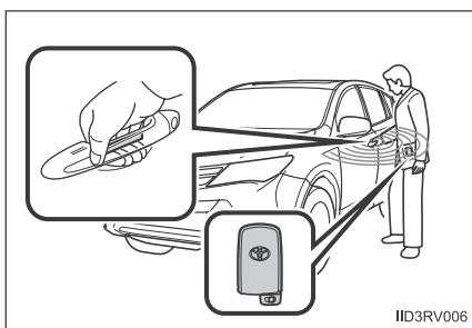
Toque no sensor de travamento (recorte na parte superior da maçaneta da porta) para travar todas as portas.
