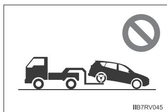
Modelos 4WD: Jamais reboque este veículo com alguma das rodas apoiadas na pista. Isto poderá causar danos severos à transmissão. Use um carrinho de rebocamento.
