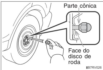
Ao substituir uma roda de alumínio por uma roda de aço, aperte as porcas até que a parte cônica esteja em contato com a face do disco da roda.
