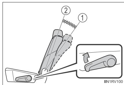
Se o sistema de segurança para crianças interferir com o apoio de cabeça e não puder ser instalado corretamente, instale o sistema após remover o apoio de cabeça. (→P. 3-3-7)
