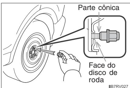
Ao substituir uma roda de alumínio por uma roda de alumínio, aperte as porcas até que as arruelas estejam em contato com o disco da roda.
