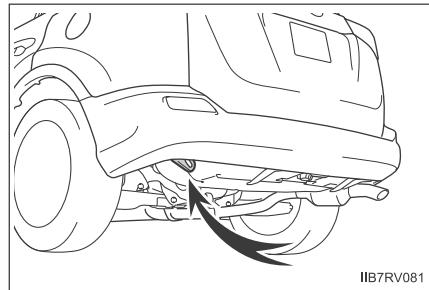
**Instalação do olhal de rebocamento**
