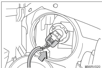
**7** Conecte o conector e instale a tampa.
