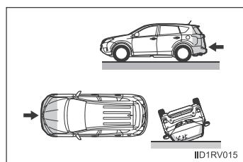
Os airbags de cortina em geral não inflam se o veículo for envolvido em uma colisão traseira, ou em caso de colisão lateral ou frontal em baixa velocidade.
