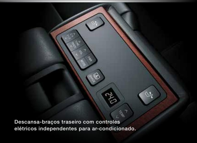
Descansa-braços traseiro com controles elétricos independentes para ar-condicionado.
