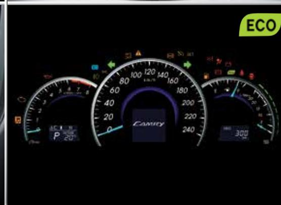
Painel de instrumentos com tecnologia Optitron e indicador ECO Driving.
