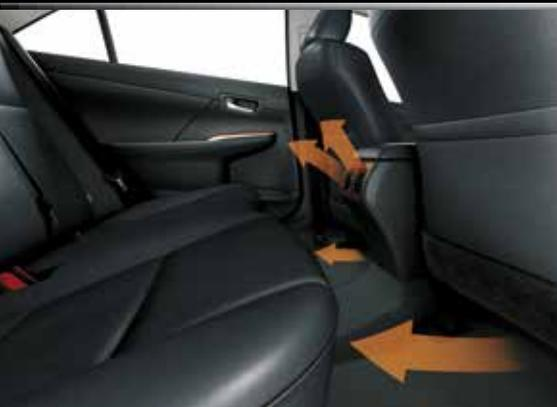
Ar-condicionado three zone: ajuste de temperatura independente para os bancos traseiros.
