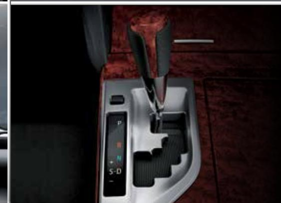
Transmissão automática de seis velocidades com modo sequencial (shiftronic), shift gate e controle eletrônico Super ECT<sup>7</sup>.
