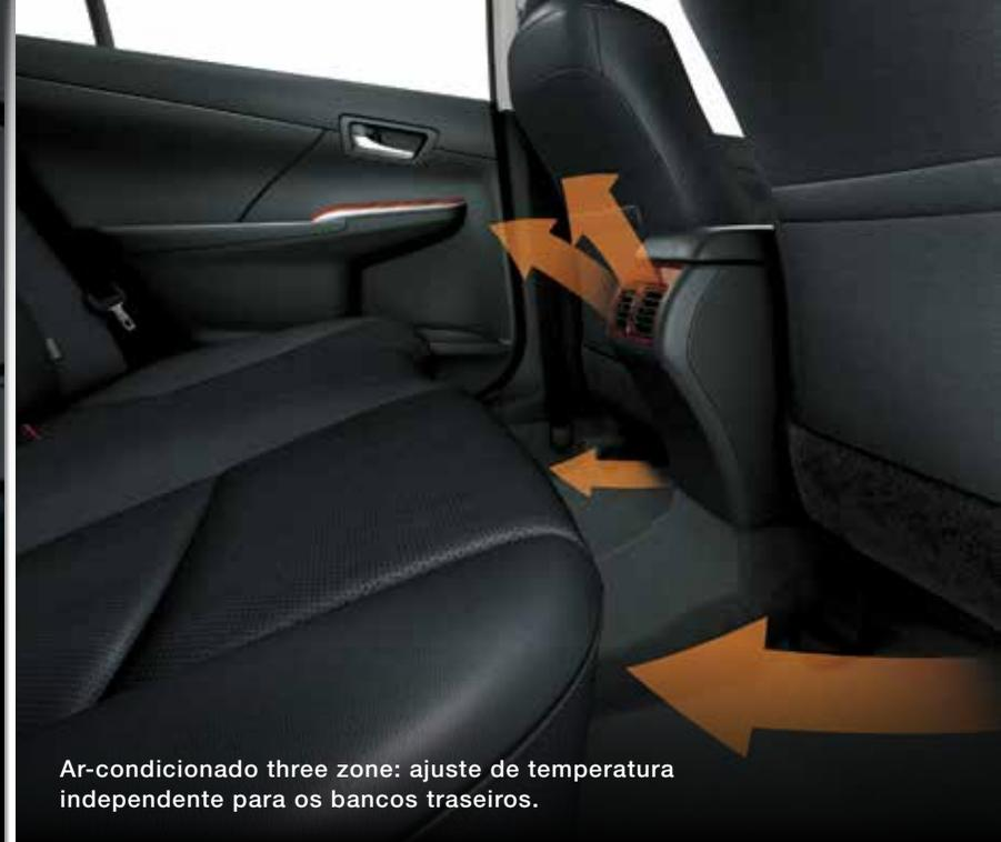
Ar-condicionado three zone: ajuste de temperatura independente para os bancos traseiros.
