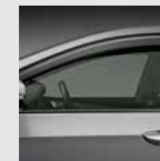
Calha de chuva
