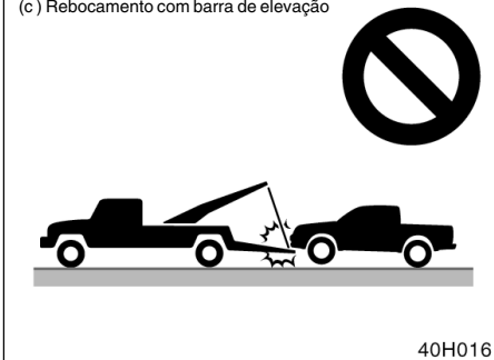
(c) Rebocamento com barra de elevação
