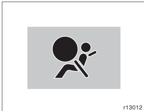
**Este indicador acende-se quando a chave da ignição está na posição “ON”. Ele se apaga após aproximadamente 6 segundos. Isto significa que os SRS airbags estão operando adequadamente.**
