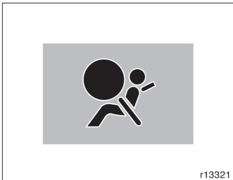
**Este indicador acende quando a chave de ignição for colocada na posição “ON”. Ele apaga após aproximadamente 6 segundos. Isto significa que os pré-tensionadores estão operando adequadamente.**
