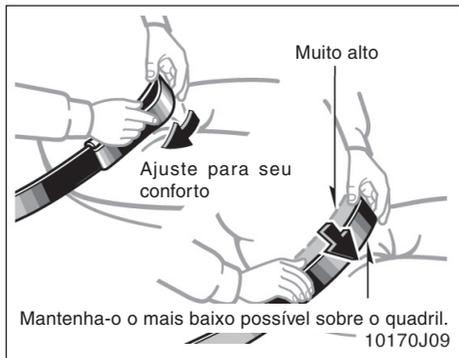
**Elimine o comprimento em excesso do cinto e ajuste sua posição.**
