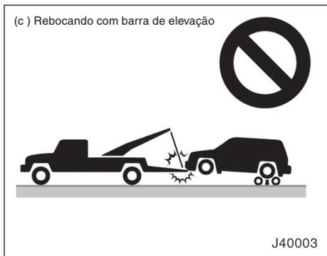
**(c) Rebocando com barra de elevação**
