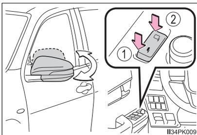
**n O ângulo do espelho poderá ser ajustado quando (ajuste de tipo elétrico)**
