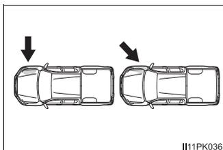
Os sistemas de airbag laterais e de cortina, em geral, não deflagram se o veículo for envolvido em uma colisão traseira, se capotar, ou ainda em caso de colisão frontal ou lateral que não atinja a desaceleração necessária.
