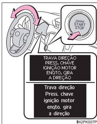
**n Precaução quanto ao superaquecimento do motor de travamento da direção**
