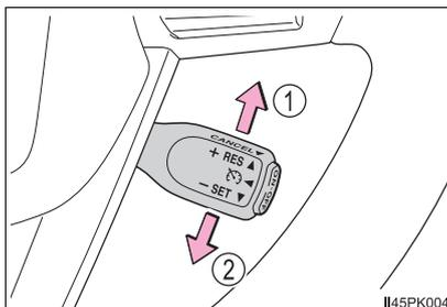
A velocidade ajustada será aumentada ou reduzida conforme segue:
