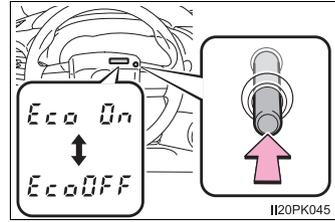
Aperte e segure o botão de comutação entre o hodômetro/hodômetro parcial por mais de 2 segundos para concluir a configuração.
