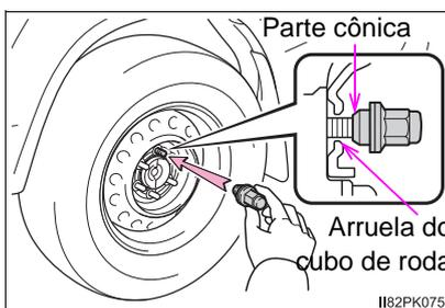
Ao substituir a roda de liga leve por outra equivalente, aperte as porcas até que a parte cônica fique presa entre em contato com o cubo da roda.
