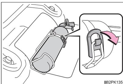
O formato do extintor e da fita de retenção e o procedimento de remoção podem ser diferente dos descritos na ilustração.
