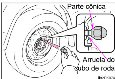
Ao substituir a roda de liga leve por uma roda de aço, aperte as porcas até que a parte cônica fique presa e, frouxamente em contato, com o cubo da roda.
