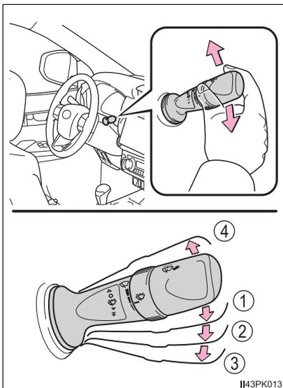
Se equipado, os intervalos do limpador podem ser ajustados quando a operação intermitente for selecionada.
