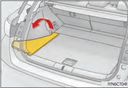
Levante a caixa auxiliar lateral esquerda.
