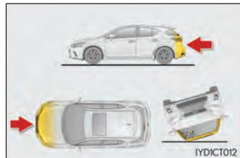
Os airbags de cortina geralmente não inflam caso o veículo se envolva em uma colisão traseira, capote, ou se envolva em uma colisão lateral ou dianteira em baixa velocidade.
