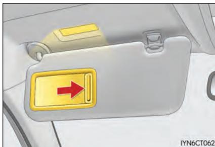
Se as luzes de cortesia permanecerem acesas quando o botão de partida for desligado, as luzes se apagarão automaticamente após 20 minutos.
