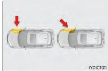
Os airbags laterais geralmente não inflam caso o veículo se envolva em uma colisão frontal ou traseira, capote, ou se envolva em uma colisão lateral em baixa velocidade.
