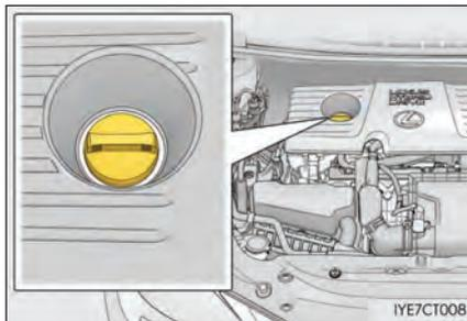
Assegure-se de verificar o tipo de óleo e prepare os itens necessários antes de adicionar óleo.
