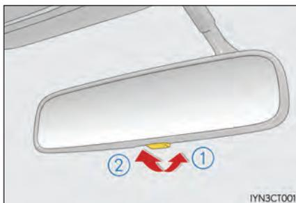
► Espelho retrovisor interno anti-ofuscante (tipo A)
