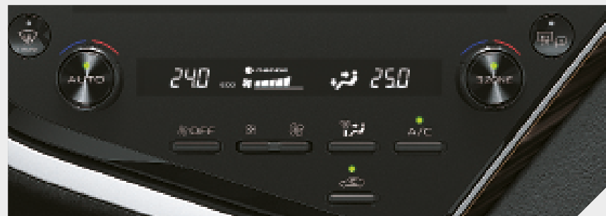
Ar-condicionado digital three zone com controle de temperatura independente para motorista, passageiro dianteiro e bancos traseiros e nova tecnologia S-Flow, que identifica quais bancos estão ocupados, direcionando o fluxo de ar
