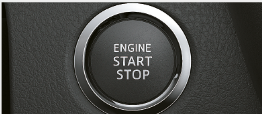
Engine Start/Stop Button: sistema de acionamento e desligamento do motor por botão
