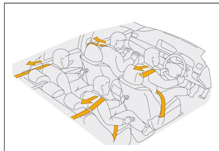
Um mecanismo do pré-tensionador é integrado ao retrator de cada um dos cintos de segurança dianteiros. Alguns modelos possuem pré-tensionadores nos cintos de segurança dos bancos traseiros.
