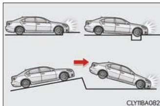
**n Tipos de colisões para as quais os airbags não foram projetados para deflagrar (Airbags dianteiros e airbag do assento do banco)**
