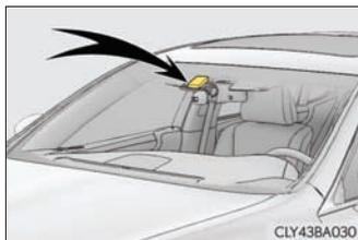
I Com o interruptor do limpador posicionado em "AUTO" e o botão de partida no modo ON (Ligado), os limpadores irão funcionar uma vez, indicando que o modo AUTO está ativado.
