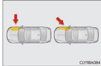
Os airbags laterais em geral não deflagram se o veículo for envolvido em uma colisão frontal ou traseira, se capotar, ou ainda em caso de colisão frontal em baixa velocidade.
