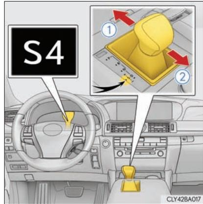
A faixa de marcha inicial no modo S é ajustada automaticamente entre 3 e 7 conforme a velocidade do veículo e as condições de condução.
