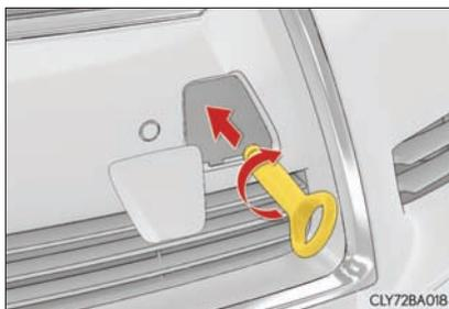
**4** Aperte o olhal de rebocamento firmemente utilizando a chave de roda.
