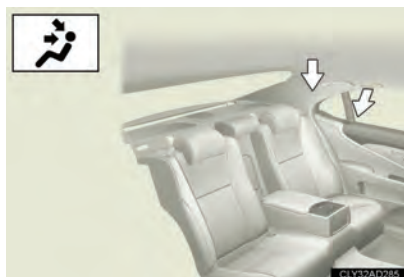
Ar frio das aberturas no teto.
