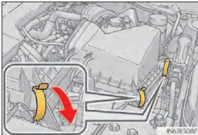
2 Levante a tampa e retire o filtro do limpador de ar.
