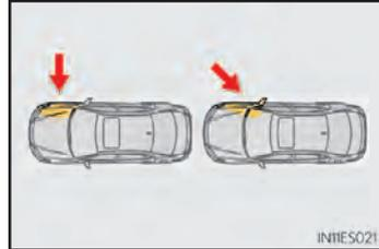
Os airbags laterais e de cortina geralmente não inflam caso o veículo se envolva em uma colisão frontal ou traseira, capote, ou se envolva em uma colisão lateral em baixa velocidade.
