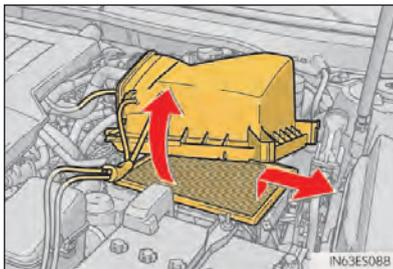
Inspecione a superfície externa do filtro, e substitua o filtro caso ele esteja extremamente sujo. Se o filtro estiver apenas moderadamente sujo, use ar comprimido para soprar a poeira do filtro.
