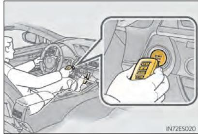
3 Pressione o pedal do freio firmemente e verifique se a
