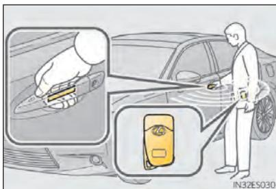
Toque no sensor de trava (na parte superior da maçaneta) para travar todas as portas.
