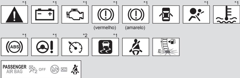
\*1: Essas luzes se acendem quando o interruptor “POWER” estiver no modo “ON”, para indicar que a verificação de sistema está acontecendo. As luzes desligarão se o sistema híbrido estiver ligado ou após alguns segundos. Pode haver uma impropriedade se a luz não acender ou se não se desligar. Leve o veículo para ser inspecionado pela sua Concessionária Autorizada Toyota.
