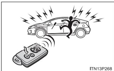
Ao pressionar (⏏) por um tempo maior do que um segundo, aproximadamente, um alarme irá soar de forma intermitente e os faróis do veículo irão piscar para inibir qualquer pessoa de tentar arrombar ou danificar seu veículo.
