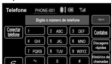
As funções do telefone viva-voz via Bluetooth® são operadas diretamente no painel de toque do sistema multimídia.
