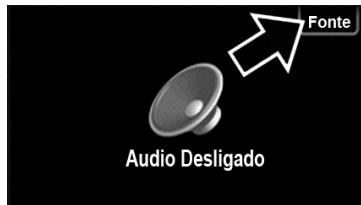
A seleção do dispositivo **[iPod]** pode ser feita ao pressionar a tecla **[Fonte]** na parte superior da tela do sistema de áudio e vídeo exibido ao ligar o aparelho, ou pressione o botão **MODE** no volante de direção\* até aparecer **[iPod]** na tela.
