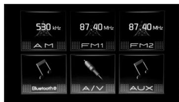
Pressione uma das teclas **[AM/FM1/FM2]** ou pressione o botão **MODE** no volante de direção\* até aparecer AM ou FM na tela. A tela exibe a estação de rádio sintonizada anteriormente.
