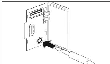
Abra a tampa da porta USB/AUX/HDMI no painel lateral direito e conecte o conector de 3,5mm do dispositivo de áudio portátil. O áudio começa a ser reproduzido automaticamente nos alto-falantes do veículo.
