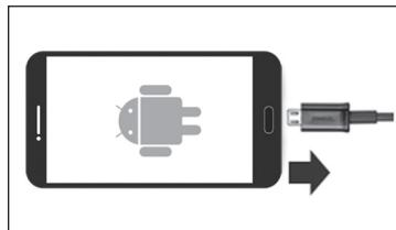
Desconecte os cabos certificados Micro-USB, HDMI e cabo adaptador MHL Samsung do sistema multimídia e do smartphone Android.
