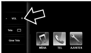
Para ajustar o volume, pressione o botão **Menu** (☰) no painel lateral do sistema multimídia até aparecer o **menu fixo** na lateral esquerda da tela. Ajuste o volume através das teclas - e + ou pressione os botões -/+ no volante de direção\*.
