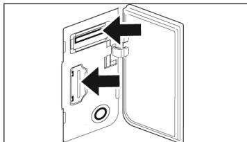
Abra a tampa da porta USB/AUX/HDMI no painel lateral direito e conecte os cabos nas entradas HDMI / USB do sistema multimídia.
