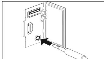
Abra a tampa da porta USB/AUX/HDMI no painel lateral e conecte o conector de 3,5mm do gravador de vídeo (VTR).
