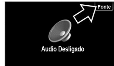
A seleção dos dispositivos [USB], [SD] pode ser feita ao pressionar a tecla **[Fonte]** na parte superior da tela do sistema de áudio e vídeo exibido ao ligar o aparelho ou ao pressionar o botão **MODE** no volante de direção\* até aparecer [USB], [SD] na tela.
