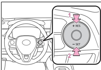
Ajuste fino: Cada toque no interruptor altera a velocidade em aproximadamente 1 km/h
