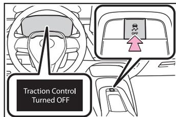
A mensagem "Traction Control Turned OFF" (Controle de Tração Desligado) será exibida no computador de bordo colorido.
