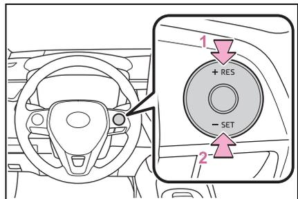
Ajuste fino: Cada toque no interruptor altera a velocidade em aproximadamente 1 km/h
