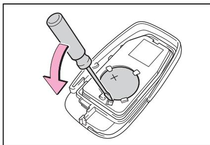
**4** Ao instalar a cobertura da chave e a chave mecânica, instale-as conduzindo a etapa 2 e a etapa 1 com as orientações invertidas.
