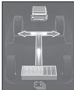
Quando o veículo for movido pelo motor elétrico e a combustão (motor de tração)
