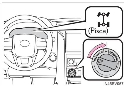
Se o interruptor do controle de tração dianteira for pressionado enquanto o veículo estiver em velocidades superiores a 100 km/h, o indicador de tração 4x4 pisca e o alarme sonoro soa.
