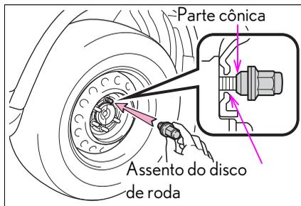
Ao substituir uma roda de alumínio por outra equivalente, gire as porcas até que as arruelas entrem em contato com o disco de roda.
