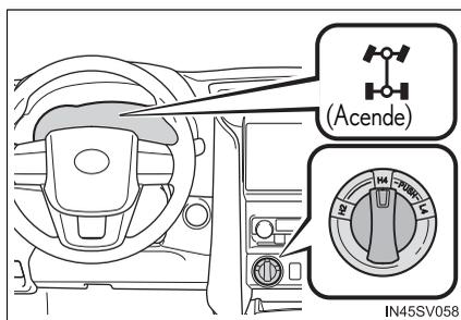
Se o indicador de tração nas 4 rodas não parar de piscar depois da comutação do interruptor do controle de tração dianteira de H2 para H4, realize qualquer um dos itens descritos a seguir ao conduzir em linha reta.
