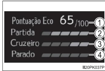
Se o pedal do acelerador não for pressionado, como quando o veículo é conduzido com o Controle de Velocidade Constante (CC) ou o Controle de Velocidade Adaptativo (ACC), a distância percorrida não é incluída na classificação Eco.
