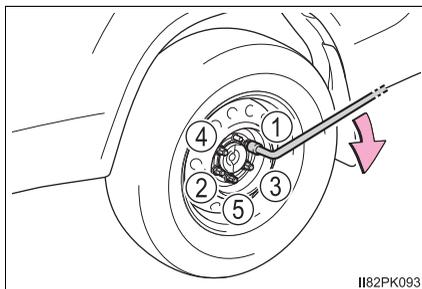
Instale manualmente a porca trava na roda.
