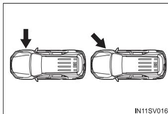
Os sistemas de airbag laterais e de cortina, em geral, não deflagram se o veículo for envolvido em uma colisão traseira, se capotar, ou ainda em caso de colisão frontal ou lateral em baixa velocidade.
