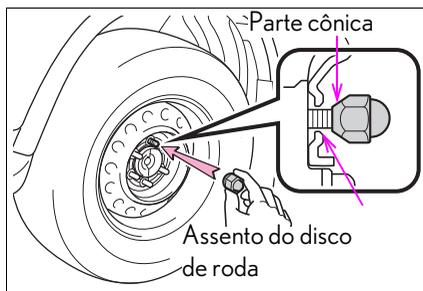
Ao substituir uma roda de alumínio por uma roda de aço, aperte as porcas até que a parte cônica fique presa e levemente em contato com o assento do disco de roda.
