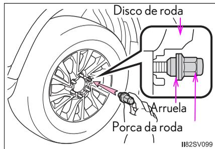
Ao substituir uma roda de aço por outra equivalente, aperte as porcas até que a parte cônica fique presa e levemente em contato com o assento do disco da roda.
