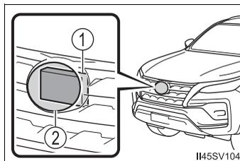
● Não fixe acessórios, adesivos (incluindo adesivos transparentes) ou outros itens no sensor de radar, na tampa do sensor de radar ou na área ao redor.
