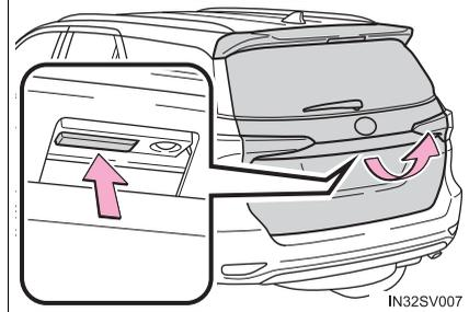
Quando a tampa traseira estiver destravada: Pressione o interruptor do dispositivo de abertura da tampa traseira
