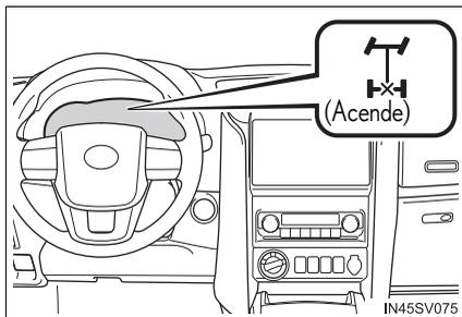
Destrave o diferencial traseiro assim que o veículo começar a se mover. Para destravar o diferencial traseiro, aperte o interruptor novamente.
