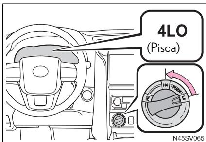
Se o interruptor do controle de tração dianteira for ativado sem seguir as etapas 1 e 2, o indicador de tração 4x4 em baixa velocidade piscará e o alarme soará. Coloque o interruptor do controle de tração dianteira em L4 e tente repetir as etapas 1 e 2 novamente.
