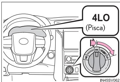
Se a alavanca for colocada em uma posição diferente de N enquanto o indicador de tração 4x4 em baixa velocidade estiver piscando, um ruído de engrenagem poderá ser ouvido. Mude a alavanca de mudança de marchas para N imediatamente, e espere que a comutação do modo de transferência seja concluída.
