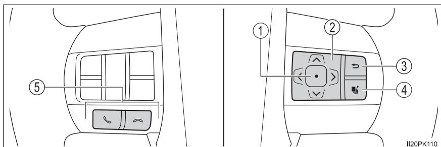
O computador de bordo colorido é acionado usando os interruptores de controle dos medidores.
