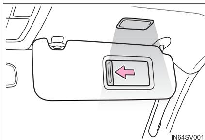
Veículos com luzes de cortesia: Se as luzes de cortesia permanecerem acesas por 20 minutos enquanto o interruptor de ignição é colocado na posição "LOCK" (TRAVADO) (veículo sem smartkey) ou depois que o botão de partida é desligado (veículo com smartkey), as luzes apagarão automaticamente.
